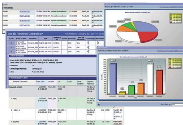
Obr.1 Equipment Operations Module – různé možnosti reportních sestav pro analýzy a dohledatelnost skutečné výrobní historie všech výrobků
