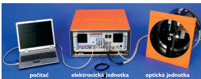
Obr.2 Komponenty systému GLD
