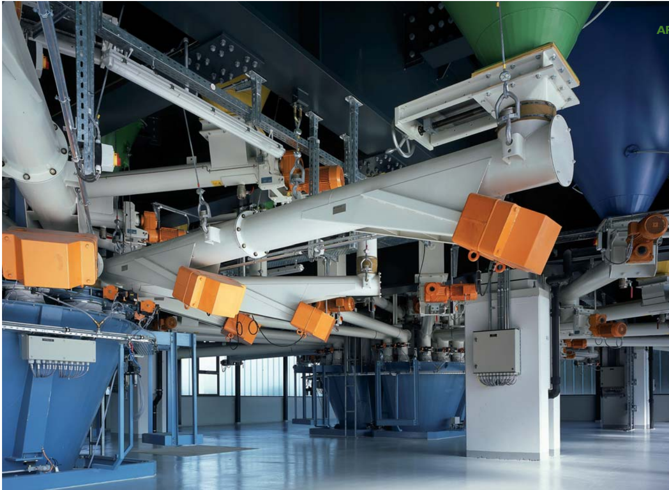
Pohľad do výrobného procesu: navažovanie suchých látok vo firme Sto AG v Stühlingene
