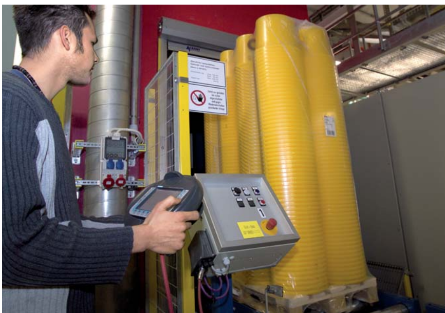
Pomocou dvoch prístrojov Simatic Mobile Panel 170 ovláda firma Sto prepravu plných a prázdnych palet
