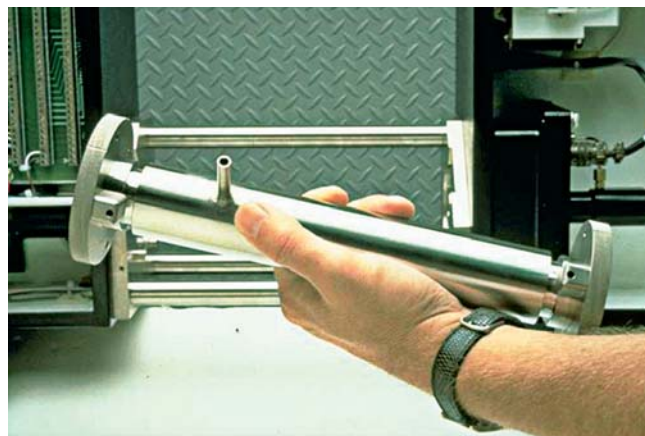
Obr.2 Umiestnenie meracej cely mimo elektroniky zariadenia
