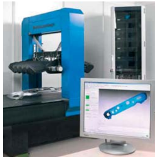
Koncepcia nového meracieho a kontrolného pracoviska s kompletným 3D meraním
