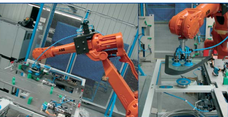
Obr.1 Robot ABB s manipulovaným sklom a pri jeho odoberaní
