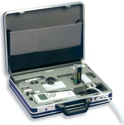
Obr.6 Vzorkovací systém Vaisala DRYCAP® DSS70A ponúka kompaktné riešenie na meranie rosného bodu v prevádzke, kde sa nedá použiť priame meranie. Typické aplikácie sú procesy ako spracovanie kovov a sušenie plastov
