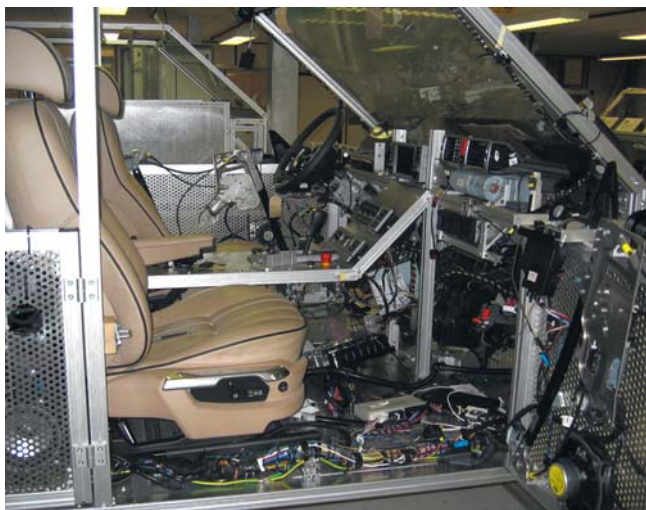
Ukázka instalovaného EBS systému a elektroinstalace automobilu při tradičních zkouškách na testovací desce (tzv. breadboard)
