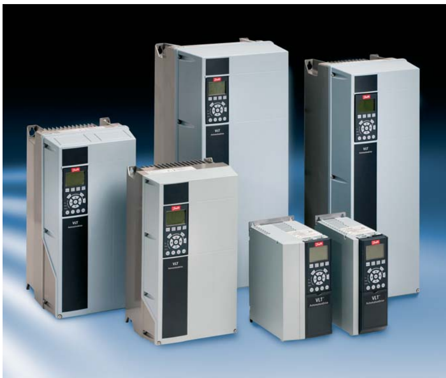
Obr.1 Meniče frekvencie Danfoss VLT vybavené indukčnosťou v medziobvode na efektívne potlačenie harmonických prúdov
