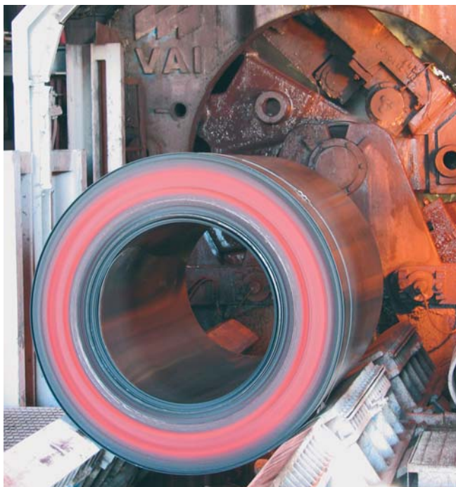
Obr.4 Hotový vyvalcovaný plech vo zvitzku
