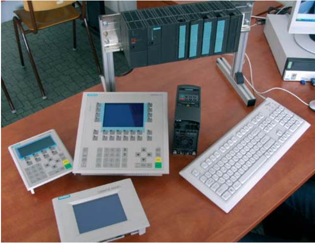
Operátorské panely využívané pri výučbe riadiacich systémov
