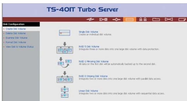
Ukážka TS-401T – okno s konfiguráciou RAID módu
