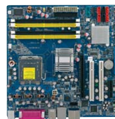
Obr.2 Jednodoskový zabudovaný počítač
