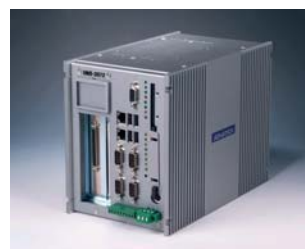
Obr.5 Zabudovaný počítač je odolnejší ako priemyselné PC
