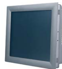
Obr.3 Zabudovaný počítač v podobe dotykového panela
