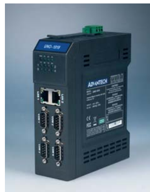
Obr.6 Zabudovaný priemyselný počítač s montážou na DIN lištu
