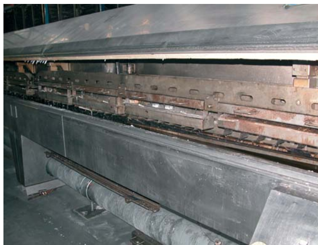
Profil vstupuje do solnej taveniny, kde je jemne sprchovaný soľou, aby sa nezdeformoval tlakom kolies. Celá sekcia sprchovania je dlhá cca 12 m
