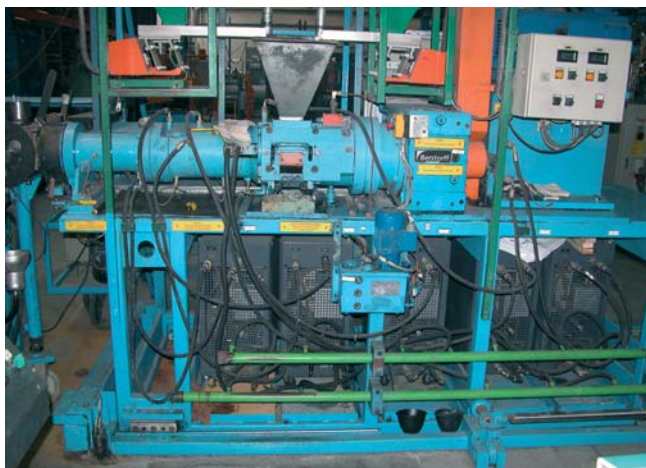
Vytlačovací stroj so závitom 60 mm spolu s temperačnými jednotkami. Vytlačovací stroj je pohyblivý, v prípade výmeny závitov sa dá odsunúť
