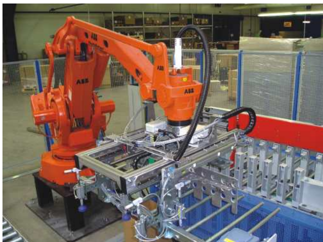
Obr.1 Paletizačný robot ABB s griprom na odber materiálu
