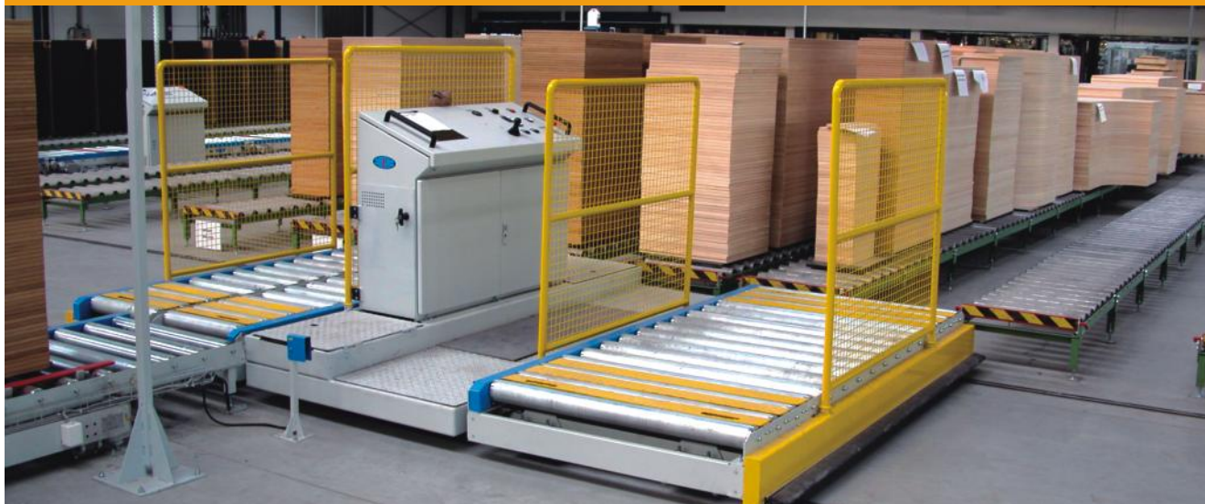
Obr. 1 Sústava dopravníkov s naukladanými paletami dielcov
