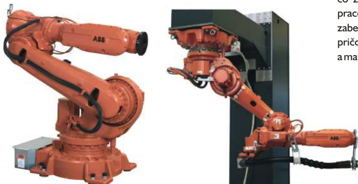
Obr. 1 Robot je schopný operovať zo šikmého podkladu, aj invertovaný
