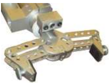
Obr. 5.: Uchopovacia čelusť s kamerou
