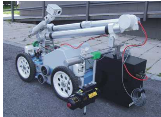
Obr. 7.: RETRIEVER s RTG súpravou
