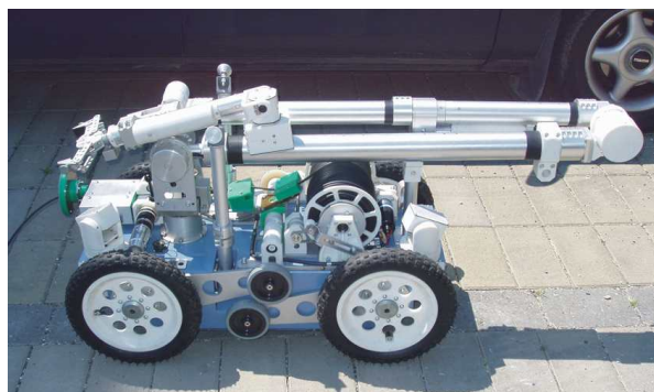
Obr. 2.: RETRIEVER s ramenom v pojazdovej pozícii
