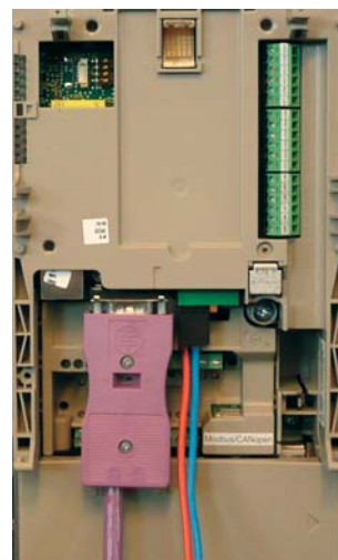
Karta Controller Inside s pripojeným napájaním a CANopen zbernicou
