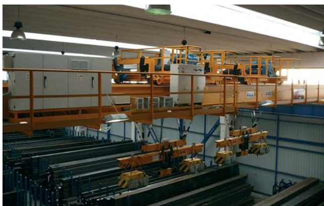
Most žeriava s mačkami pri sebe a so zdvihnutými traverzami
