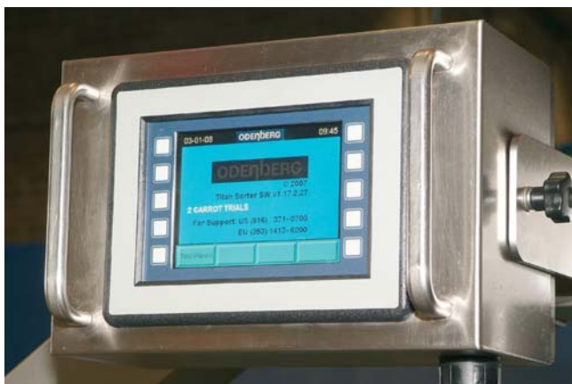
Dotykový displej na pohodlné ovládanie a nastavovanie parametrov aj v prostredí fabrik, v ktorých sa stroj každodenne oplachuje vodou pod tlakom
