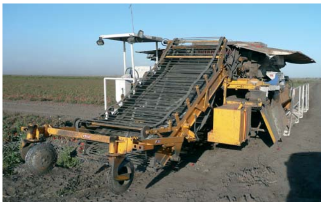
Celkový pohľad na kombajn slúžiaci na zber paradajok, využívajúci mobilný triediaci stroj
