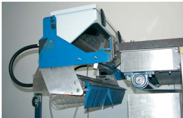
Prsty aktivované stlačeným vzduchom počas testovacej fázy na novom stroji
