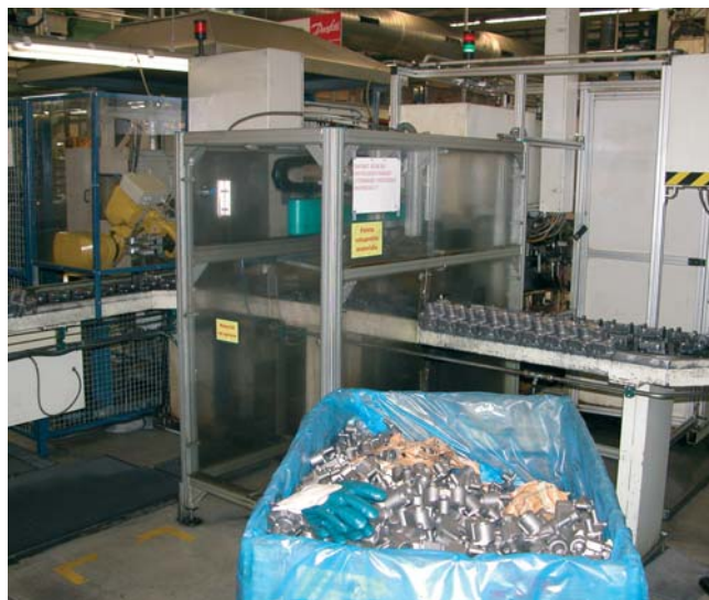
Vstupná časť dopravníka. Na tomto mieste sa na dopravník nakladajú odliatky, ktoré sú dopravované do stroja Jestadt
