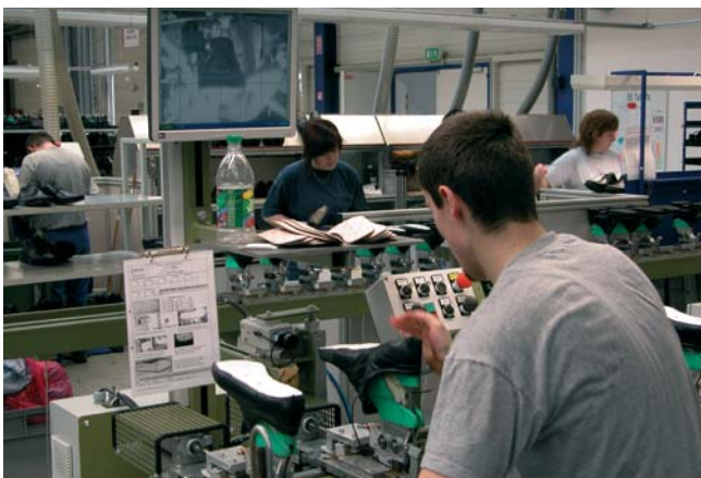
Obúvanie zvršku na kopyto na obúvacej stanici na dopravníkovom páse
