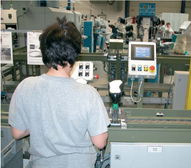
Stanica (pracovisko) lepenia výstuží do podrážok. Vpravo je informačný a nastavovací dotykový panel NS Screen
