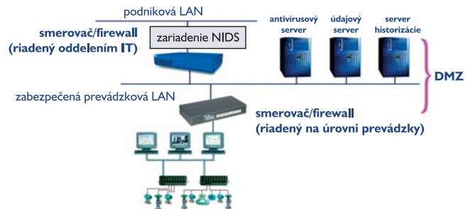
Obr.7 NIDS môže poskytnúť dodatočnú bezpečnosť systému DeltaV
