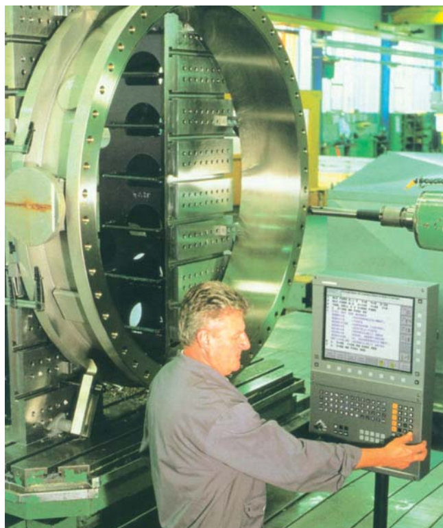
Obr.10 Príprava riadiaceho programu na CNC riadiacom systéme firmy HEIDENHEIN systémom dielenského programovania
