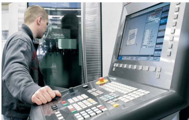
Pomocou dielensky orientovaného obslužného rozhrania ShopMill môže odborný pracovník programovať kontúry jednoducho priamo na stroji
