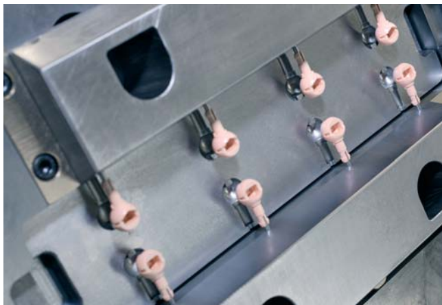
Vstrekovacia forma na výrobu hlavičiek figúrok,...
