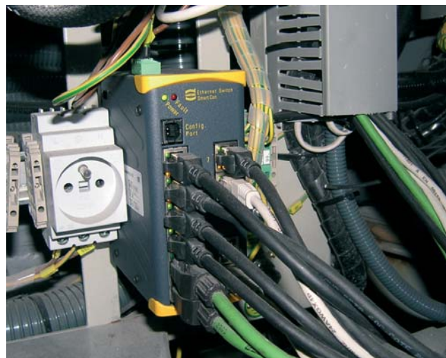
Obr.5 Nastaviteľný switch HARTING sCon 3100 s funkciou paralelná redundancia, úspešne použitý firmou LOKEL v kamerovom systéme vlakových súprav
