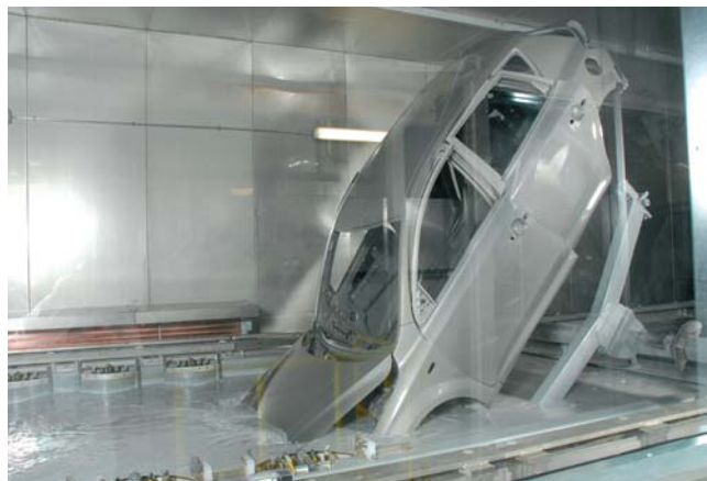
Ponorno-rotačný systém na linke elektrodepozície v lakovni
