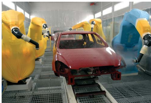
Sprejovacia kabína v prevádzke lakovne
