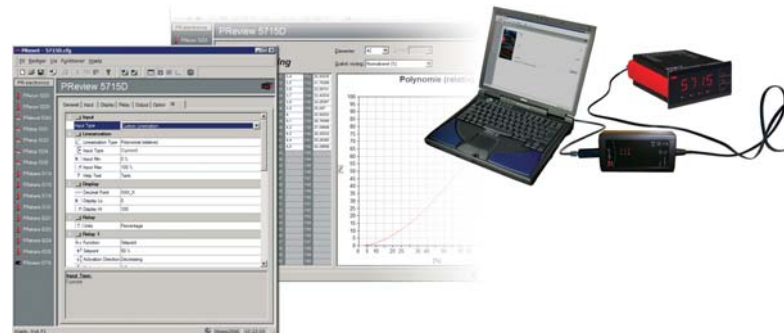
Obr.2 PReview 5715 linearizácia zásobníka PHM
