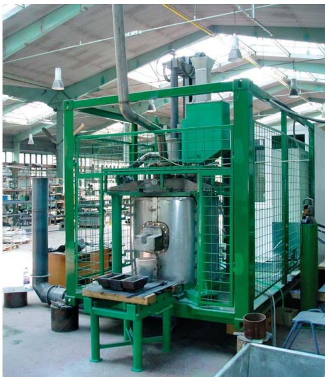
Obr.5 Kontajnerový plazmový reaktor s výkonom 80 kW
