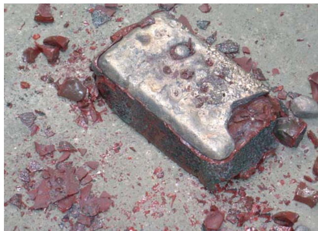
Obr.2 Výsledok tavby v reaktore
