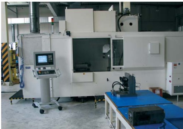
Celkový pohľad na obrábacie centrum Heller BEA 1 po vykonaní celkového repasu
