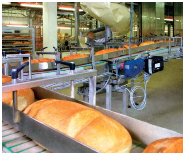
Obr.5 Transport chlebov k rezaciemu zariadeniu pomocou techniky Nord
