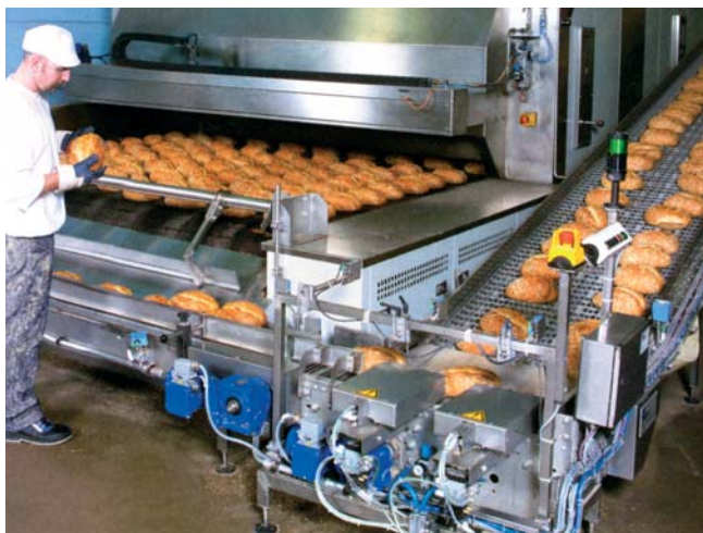
Obr.4 Koniec trasy pečenia s kontrolou kvality a presunom na ďalšie spracovanie
