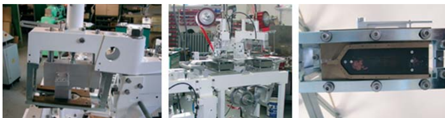
Obr.1 Aplikátor odtrhávacieho pásika s detailnými zábermi na strihacie zariadenie
