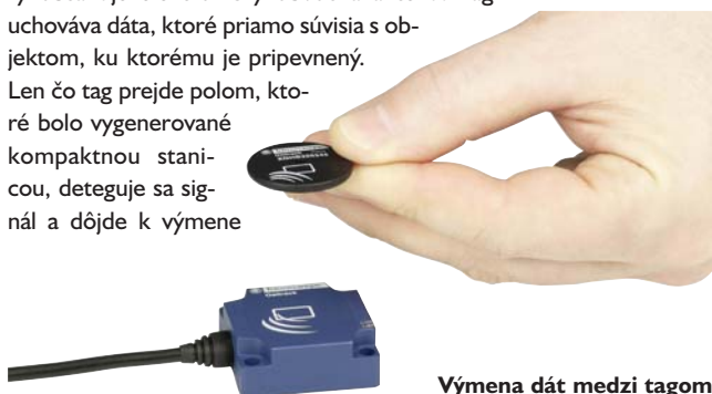
Výmena dát medzi tagom a kompaktnou vyhodnocovacou stanicou
