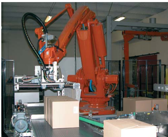
Robotický paletizátor so vstupnou sekciou dopravníkov
