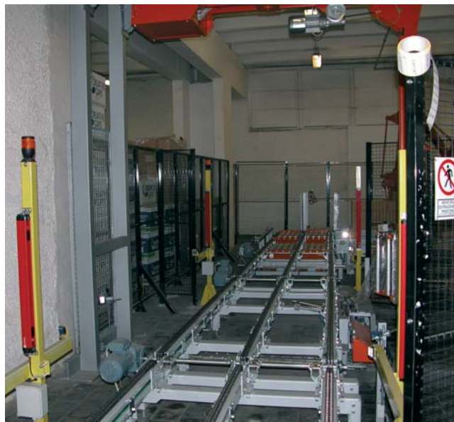
Sekcia reťazových dopravníkov palet na vstupe do ovinovacieho zariadenia
