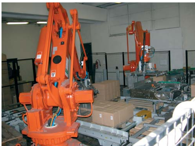
Celkový pohľad na paletizačné pracovisko s dvojicou paletizačných robotov
