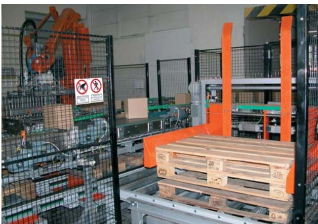
Časť robotizovaného pracoviska so zásobníkom palet
