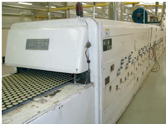
Vstup do 4-komorovej pece
