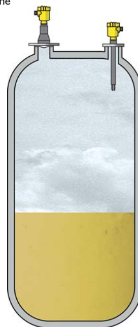
Obr.1 Hladinoměry na zásobníku s kapalným chlorem
