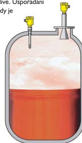
Obr.3 Hladinoměry na zásobníku s toxickou kapalinou
