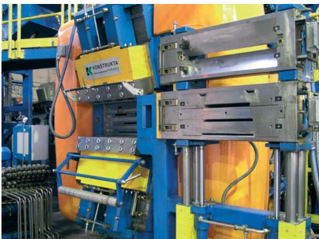
Predšablóna združuje výstupy z jednotlivých kanálov vytlačovacej hlavy do jednej úrovne
