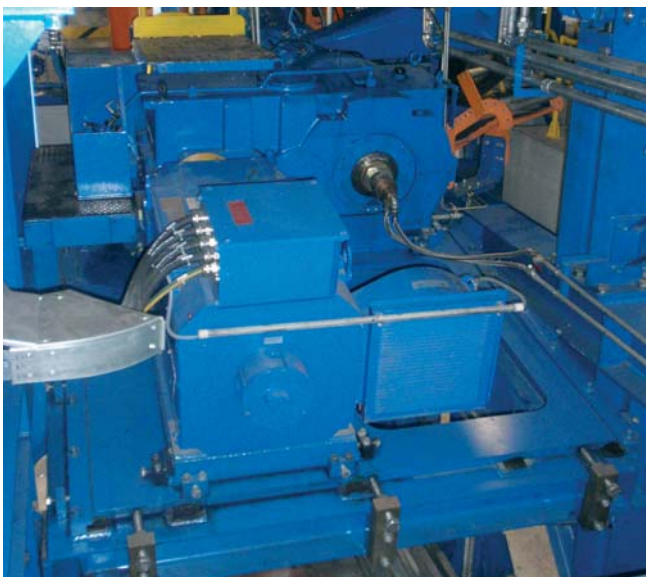
Na vytlačovacie stroje sa používajú motory série 1 PH 7 a 1 PH 8 od spoločnosti Siemens
