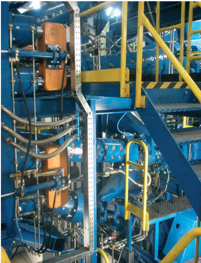
Agregát pozostáva zo štyroch kolíkových vytlačovacích strojov (extrudérov)
