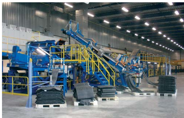
Zásobovacie dopravníky vytláčovacej linky Quadroplex
