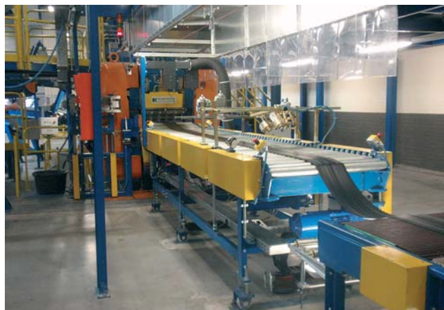
Zrážací dopravník nachádzajúci sa za vytlačovacím agregátom
