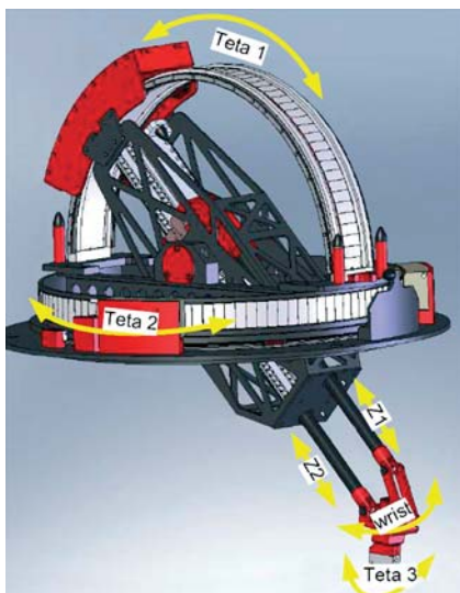
Obr.1 Galileova guľa – nový robotický koncept na manipuláciu malých produktov
