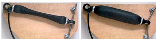
Obr.3 Nenatlakovaný a natlakovaný opletený pneumatický umelý sval firmy Shadow Robot Company [11]
