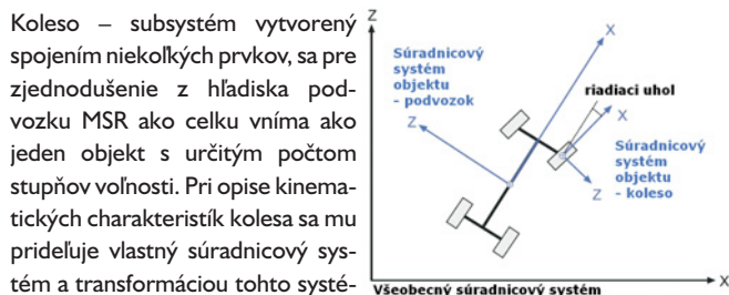
Obr.1 Súradnicové systémy kolesového mobilného podvozku
