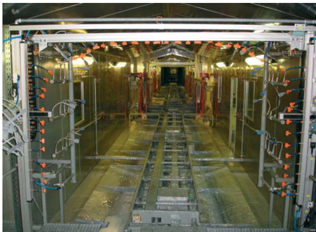
Plno automatický portál ofukovania karosérií
