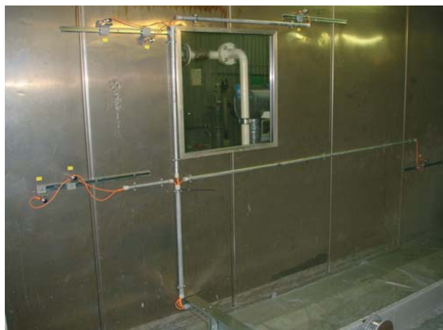
Osem optických snímačov na detekciu typu karosérie
