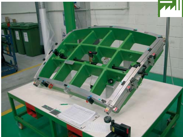
Master Fixture na kontrolu parametrov skiel
