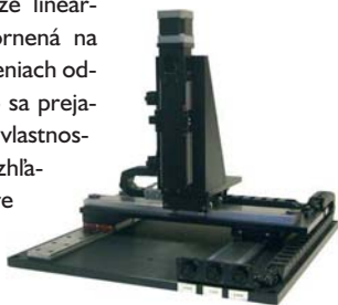
Obr.8 Trojosová polohovacia jednotka na báze lineárnych krokových motorov
