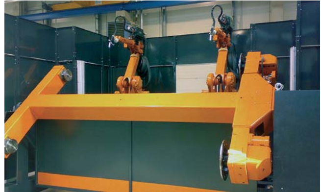
Obr.3 Pohľad na naposledy dodanú bunku MultiMove s dvoma zvaracími robotmi počas realizácie projektu
