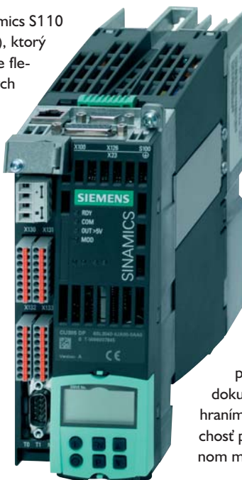
Modulárny Sinamics S110 s výkonovým modulom PM340, riadiacou jednotkou CU305 vo variantoch s komunikačnými rozhraniami Profibus DP, CAN Open a Profinet (pripravuje sa) a so základným obslužným panelom BOP (Basic Operator Panel)
