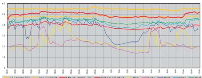
Obr.3 Priebeg teplôt v rozvodnej sústave TV s nevyváženou cirkuláciou
