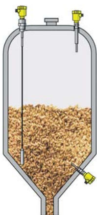
Obr.1 Hladinoměry na zásobníku pro skladování ječmene
