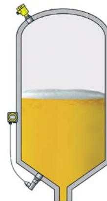
Obr.2 Hydrostatické měření výšky hladiny kapaliny s pěnou v uzavřené nádobě dvěma převodníky tlaku
