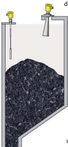
Obr.1 Měření výšky hladiny při nepravidelném povrchu asfaltu
