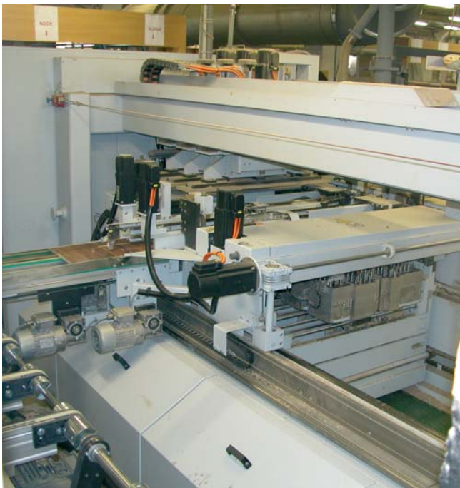
Pohľad na vertikálne suporty vrtacieho centra
