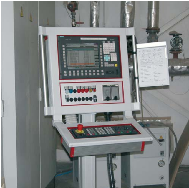
Mobilný ovládací panel päťosovej CNC frézy
