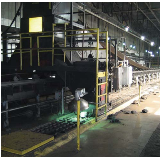
Uhoľná elektrárňa v USA používa na automatizáciu procesu plnenia zásobníkov uhlia systém so zavážacím vozíkom a meracím členom SITRANS LR460, ktorý meria výšku hladiny uhlia v každom zásobníku
